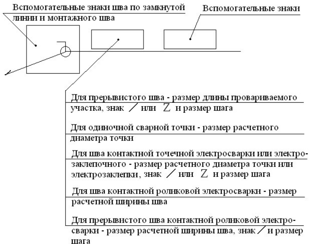
Рисунок В.12 - Схема условного обозначения нестандартного шва
