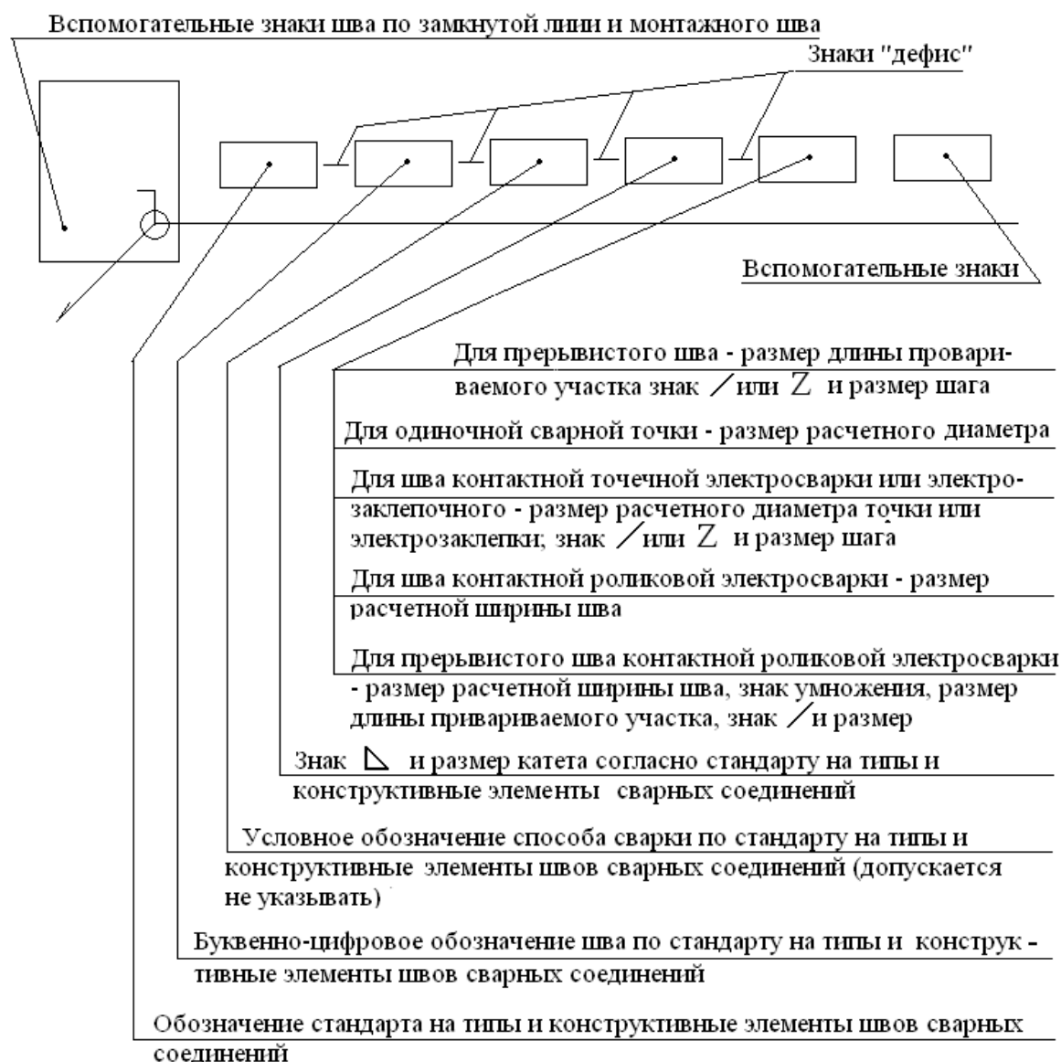
Рисунок В.10 - Схема условного обозначения стандартного шва
