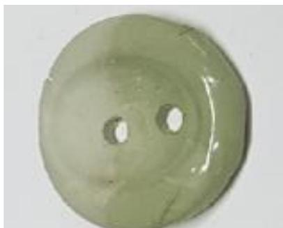
**Рис. 2. Выбранный образец с добавлением 2,5%  $\text{Cr}_2\text{O}_3$**
