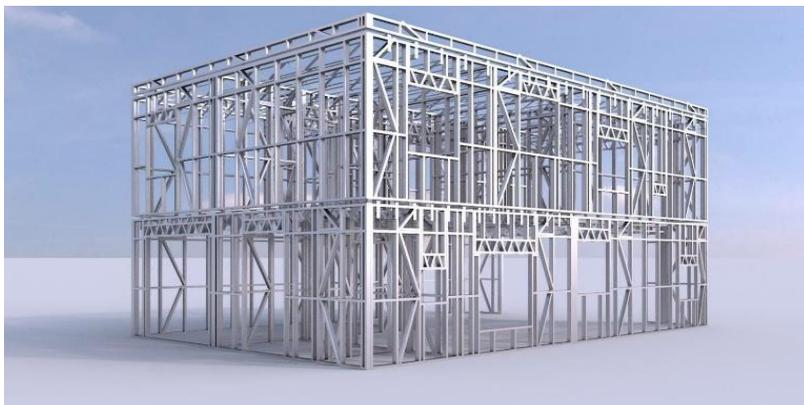
**Рис. 1. Схема каркаса здания из ЛСТК**
