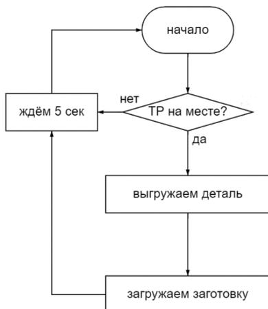
Рис. 1. Блок-схема работы робота-манипулятора
