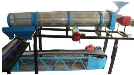
**Рис. 1. Общий вид барабанной сушилки**
