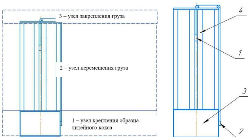
**Рис. 1. Схема испытательной установки для оценки прочности литейного кокса**
