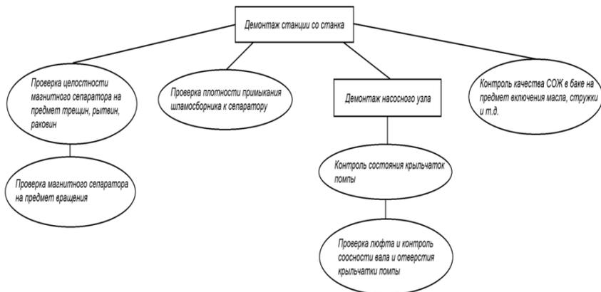
**Рис. 2. Унифицированный порядок выполнения первичной диагностики станции СОЖ плоскошлифовального станка 3Г71М**
