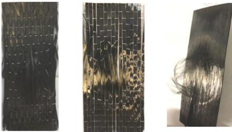
**Рис. 3. Визуальное состояние образцов после 5 минут воздействия огня**
