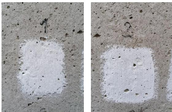
**Рис. 1. Выкрасы силикатных красок в атмосферных условиях**
