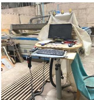
**Рис. 4. Гидроабразивный станок**
