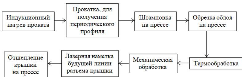
**Рис. 8. Маршрут изготовления шатуна по модернизированной технологии**
