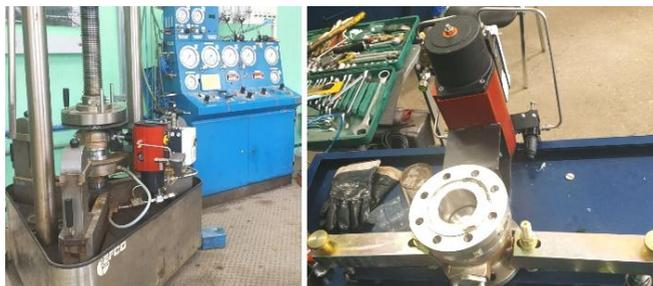
**Рис. 1. Клапан отсечной шаровой ГОСТ 21345-2005 с пневмоприводом на контрольных испытаниях в мастерской ремонтно-механической группы цеха №15 ПАО «Славнефть-ЯНОС»**
