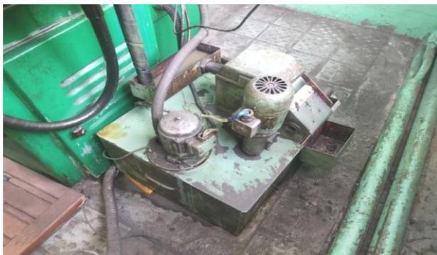
**Рис. 1. Внешний вид станции очистки СОЖ плоскошлифовального станка 3Г71М**
