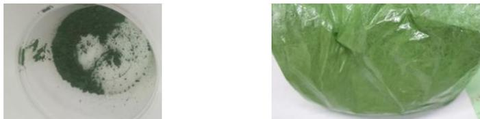
**Рис. 1. Оксид хрома в порошкообразном виде**
