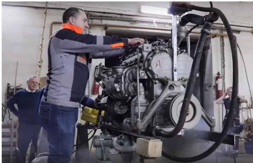
Работа с дизелем при восстановлении тягача ЯАЗ 221
