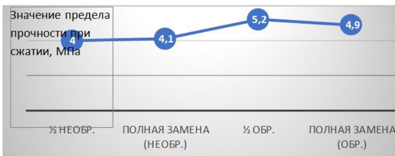
Рис. 2. Зависимость предела прочности при сжатии от обработки металлургического отхода
