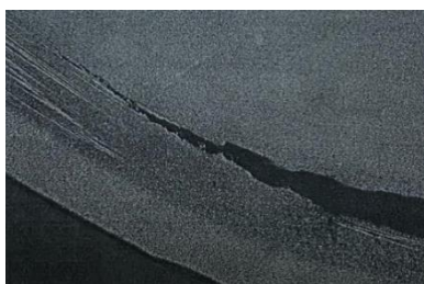
Рис. 2. Микроструктурное исследование разрыва (увеличение \times 0,25 )
