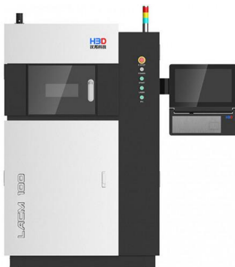
Рис. 2. Промышленный 3D принтер H3D LACM 100
