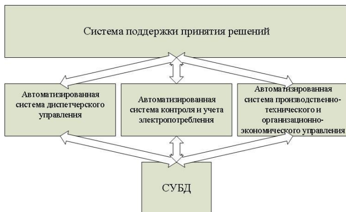
Рис. 1. Состав системы поддержки принятия решений при оперативно-технологическом управлении
