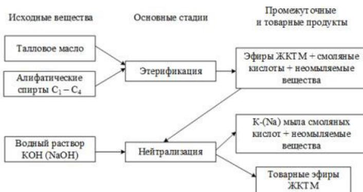
Рис. 1. Блок-схема метода получения добавки
