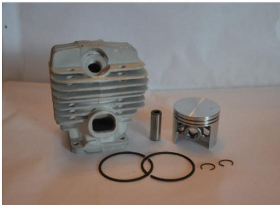
Рис. 2. Цилиндропоршневая группа опытного ДВС
