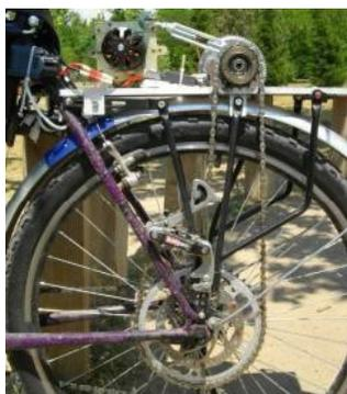
**Рис. 5. Велосипеды с отдельным блоком электродвигателя**
