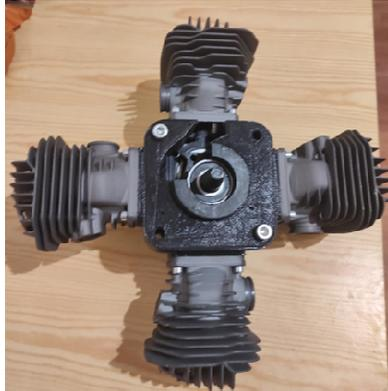
**Рис. 4. Опытный ДВС с бесшатунным механизмом в сборе**
