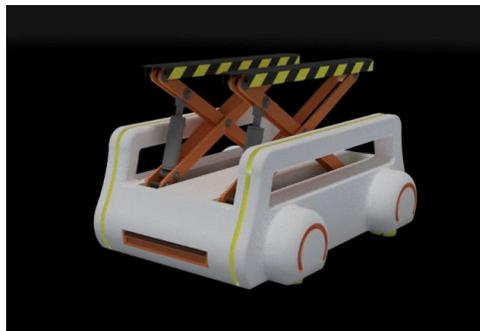
**Рис. 2. Автоматическая управляемая тележка**
