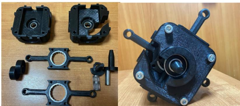
Рис. 3. Детали и бесшатунный механизм в сборе
