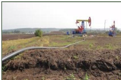
**Рис. 1 Транспортировка нефтепродуктов с помощью мобильной трубопроводной системы**
