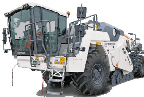
**Рис. 1. Ресайклер-стабилизёр для холодной регенерации [3]**
