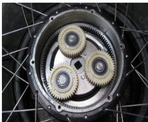
**Рис. 2. Мотор-колесо с планетарным редуктором**
