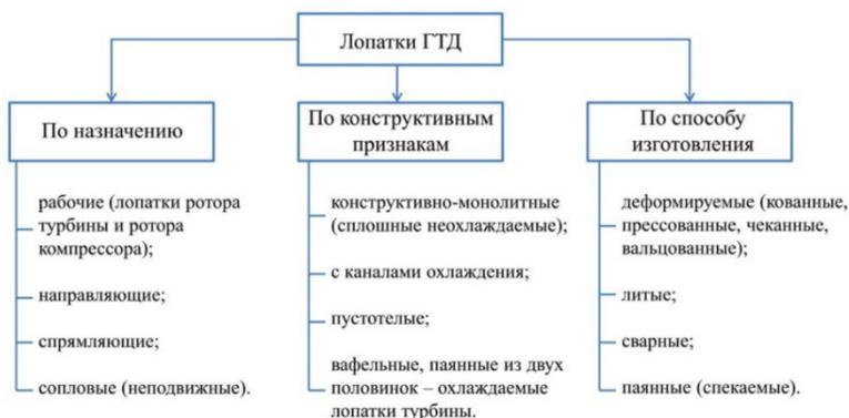
**Рис. 1. Классификация лопаток ГТД**
