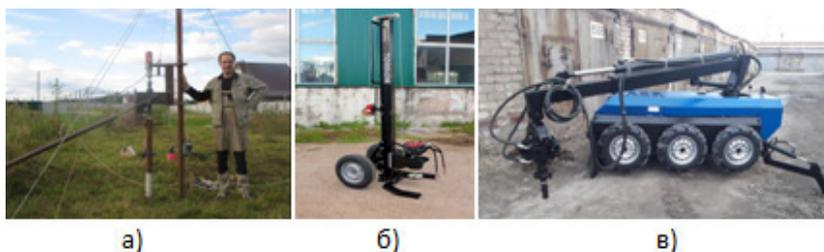
**Рис. 1. Виды оборудования для завинчивания свай [1]:**
