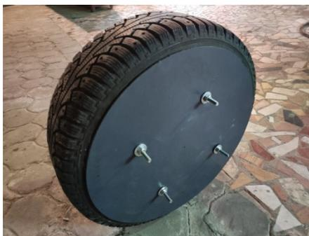
**Рис. 3. Экспериментальный образец пневмошинного рабочего органа дорожного катка с изменяемой жёсткостью**
