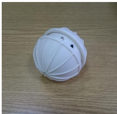
Рис. 2. Робот «Шаробот», прототип версии 1 (а, б) и версии 2, с грунтозацепами (в, г)
