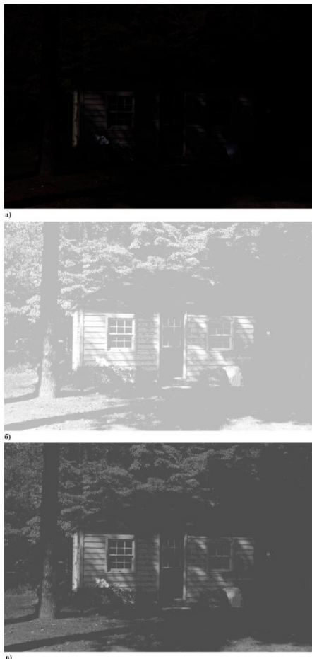
Рис. 1. Обработка а) исходного изображения с помощью: б) равномерного распределения и в) нормального с параметрами \mu = 50 , \sigma = 44
