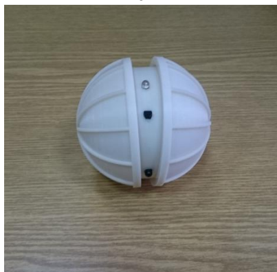
Рис. 2. Робот «Шаробот», прототип версии 1 (а, б) и версии 2, с грунтозацепами (в, г)
