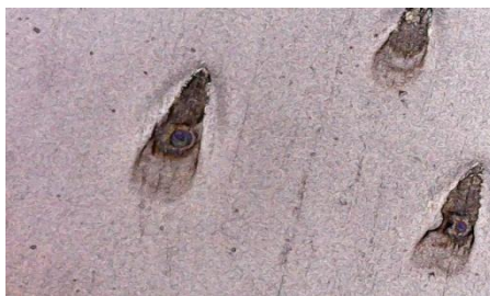
Рис. 1. Видимые под микроскопом поры блестящего никелевого покрытия
