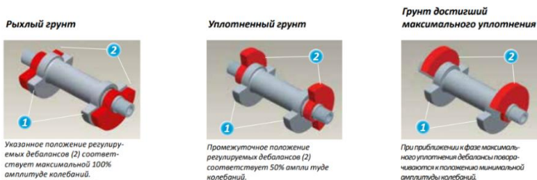
Рис. 1. Конструкция вибровозбудителя DYNAPAC[4]
